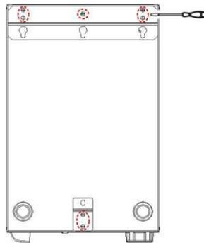
**Schritt 2:** Markieren Sie die Installationsposition mit der Montageplatte 1. Der Abstand zwischen den beiden Befestigungslöchern beträgt 300 mm.
